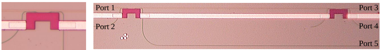
図 5.8 (左) g_h = 1.65 \mu\text{m} として試作した \text{TE}_0\text{-TE}_1 モードディバイダと(右)測定用に試作した縦続接続した \text{TE}_0\text{-TE}_1 モードディバイダの写真
