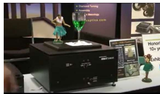
図 1. 19 Minus K Technology が開発する硬化型復元力特性を用いた防振装置 [Minus K Technology 1.41, 1.42) より引用]
