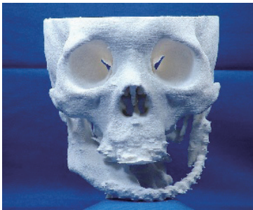
図2. 粉末積層3Dプリンター「Z402 system」（Z Corporation）で製作した手術シミュレーション用3D頭蓋骨模型（下顎骨プレート再建症例）
