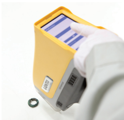
付図3 ポータブル蛍光X線分析による材質調査
