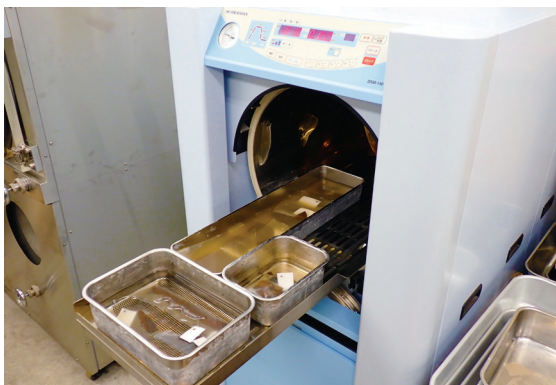
付図5 高温高圧脱塩処理装置（オートクレーブ）
