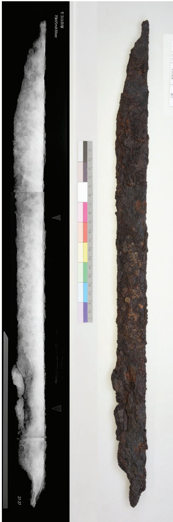
付図 13 令和 3 年度保存処理した曲手刀剣と X 線透過写真（メタル残存状況と破損・破断箇所）
