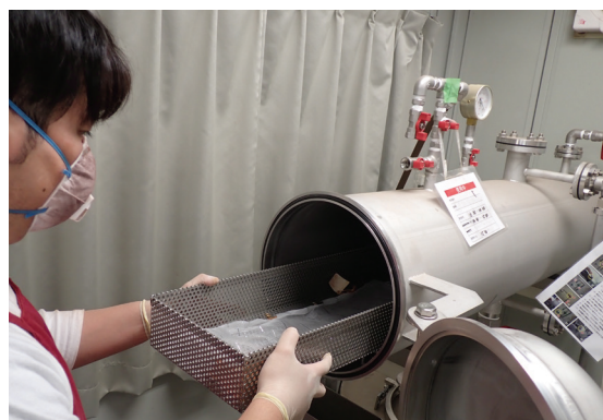
付図8 樹脂含浸処理
