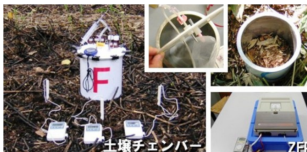
図-4. 閉鎖式チェンバーとサンプリング ZFF は CO 2 モニター。
