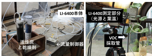
図-5. 光合成・蒸散、BVOC の測定の様子
