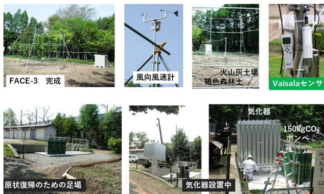
図-5. FACEの制御部分（上段）と気化器の設置（下段）
