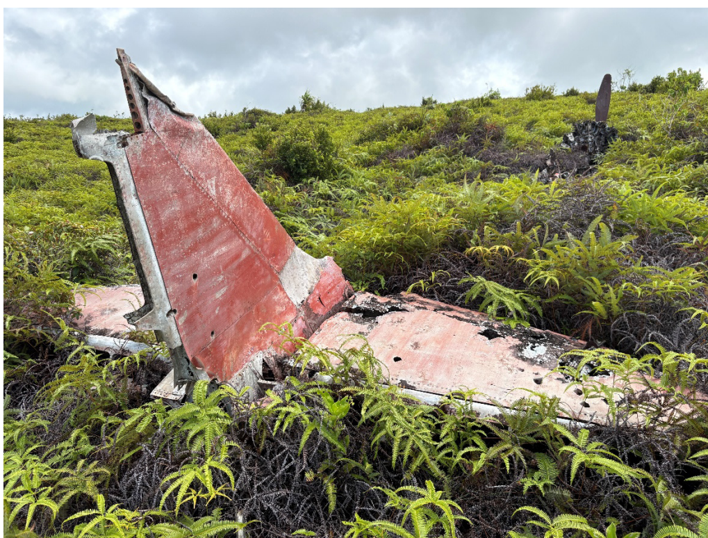
写真 7 弾痕が残る垂直・水平尾翼
