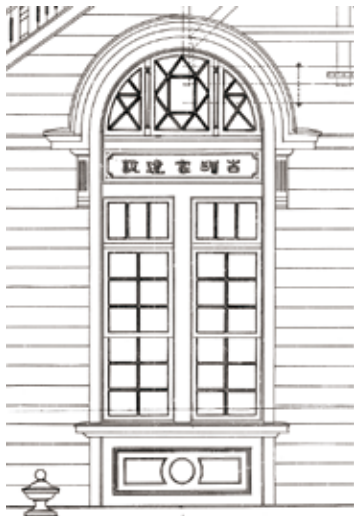
図2 東北帝国大学農科大学林学教室正面妻及玄関各部詳細図 (部分：北海道大学大学文書館所蔵)
