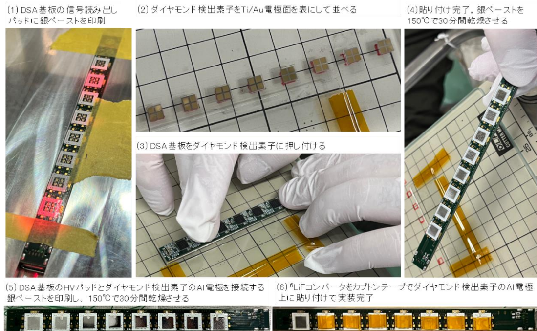
図 6.6 DSA 基板上へのダイヤモンド検出素子と ^6\text{LiF} コンバータの実装手順
