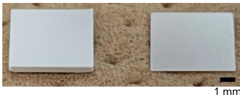
図 3.2 ^6\text{LiF} 中性子-荷電粒子コンバータ (左)研磨前、(右)研磨後
