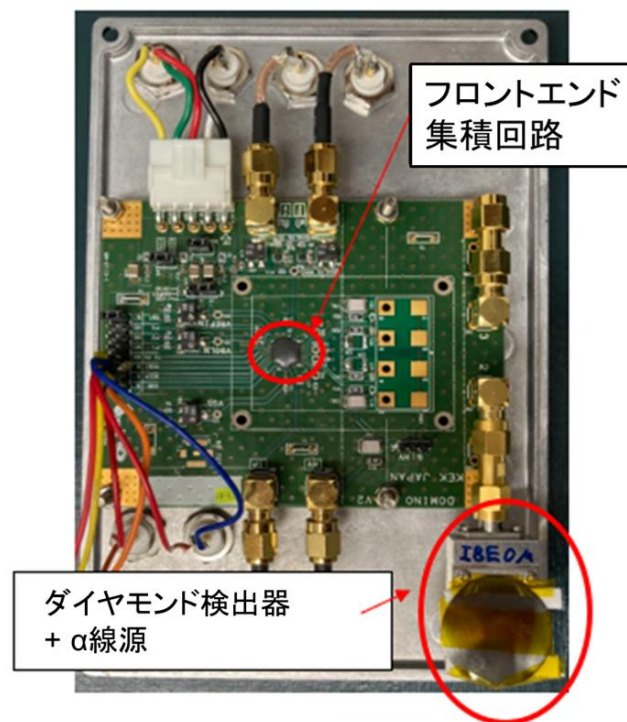
図 3.3 KEK 設計のフロントエンド集積回路を用いた信号処理回路+ダイヤモンド検出器
