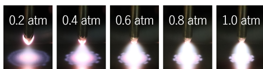
図 5.2 発光模様の形成に対するガス圧力変化の影響。
