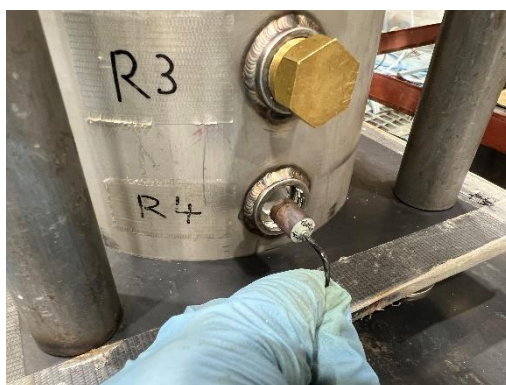
(c) 間隙水圧計の挿入
