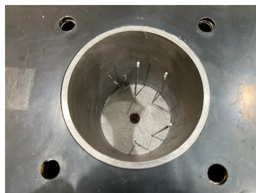
(b) 沈下板設置完了
