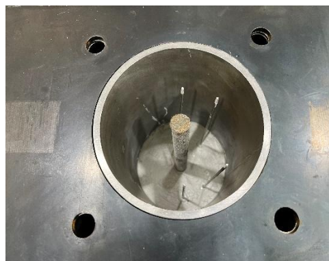
(b) 凍結サンドドレーンの挿入過程
