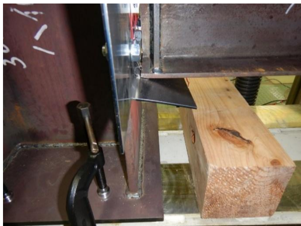
写真 3-41 供試体 T2 の変形性状
