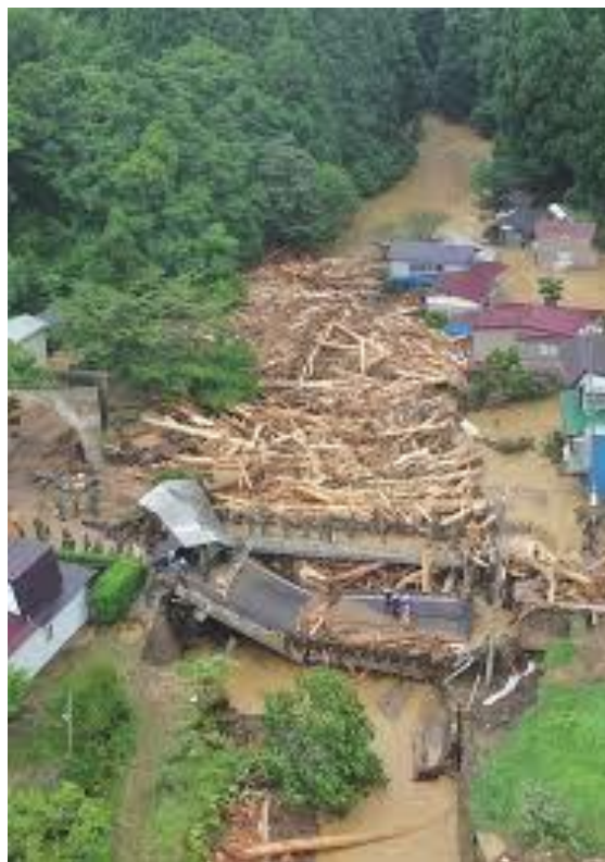
写真 2-3 小赤川の小赤川橋上流の河道に多量の土砂・流木が堆積 2),3)
