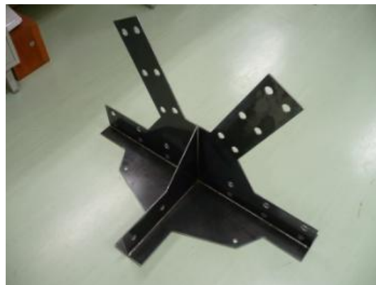
(e) 2010 年モデルの中間部連結鋼板
