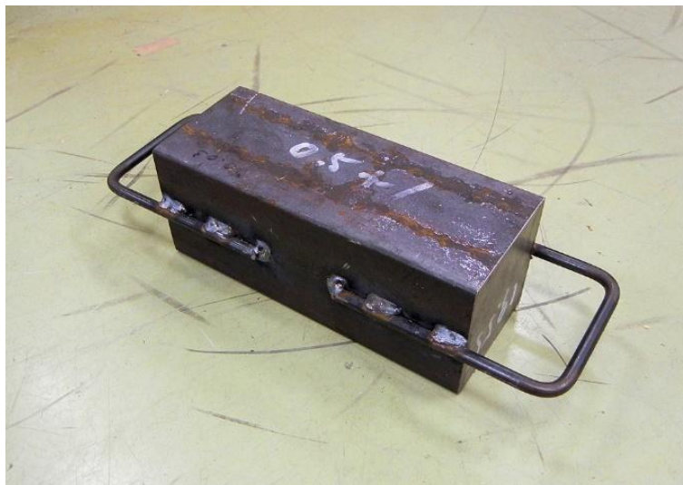
写真 4-8 載荷試験の重り
