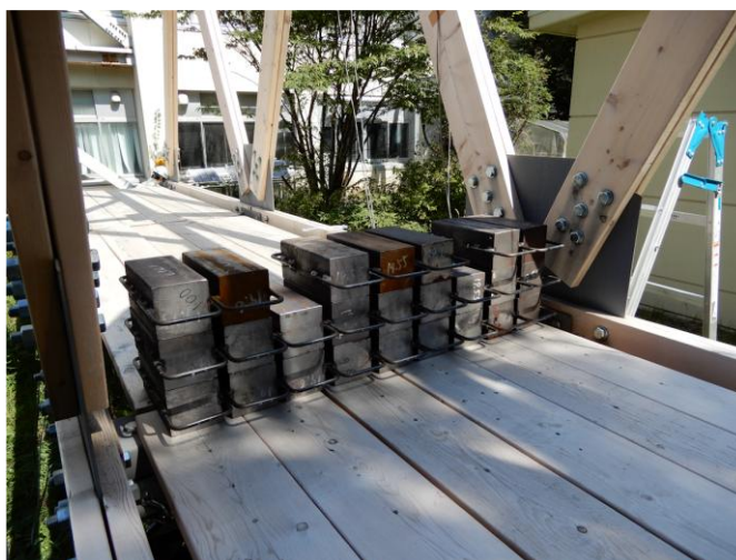
写真 3-33 載荷試験状況
