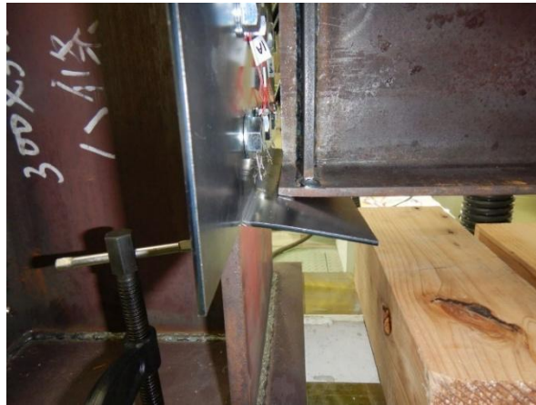
写真 3-42 供試体 T3 の変形状
