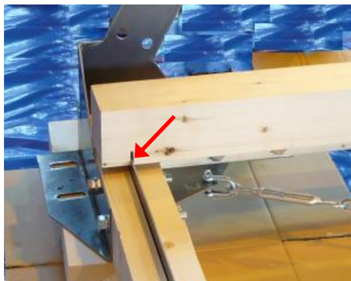
写真 3-1 床版のずれ止め
