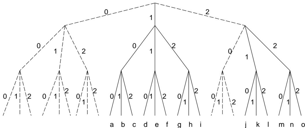
図 15: この問題での符号語に対する符号の木.  $x_1 = 0, x_2 = 20$  のように符号を選んだ場合,  $x_3, x_4$  として採用できる長さ 3 の符号としては図の a~o 中のいずれかとなる。(破線でたどられる符号を用いることはできない)
